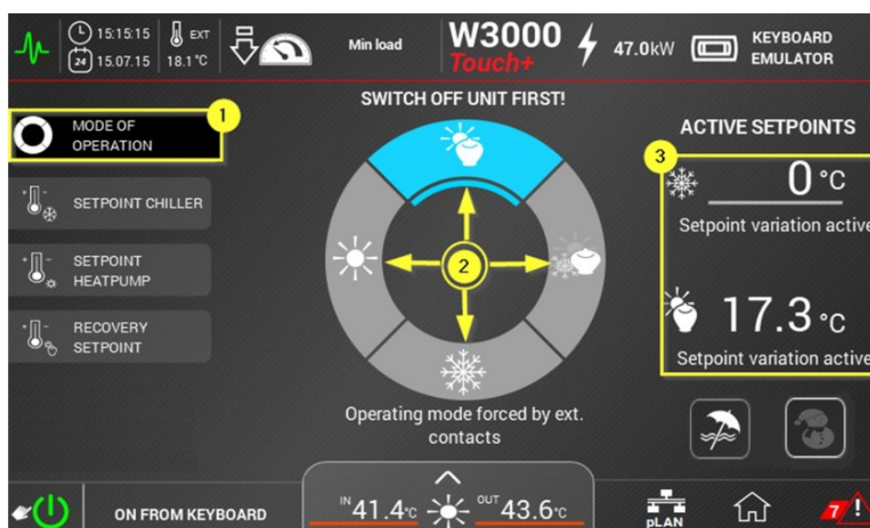
Abb. 8.13: Einstellung Betriebsart des Geräts
