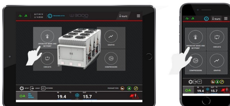
Abb. 8.20: Zugang zu Betriebsart und Sollwert.
