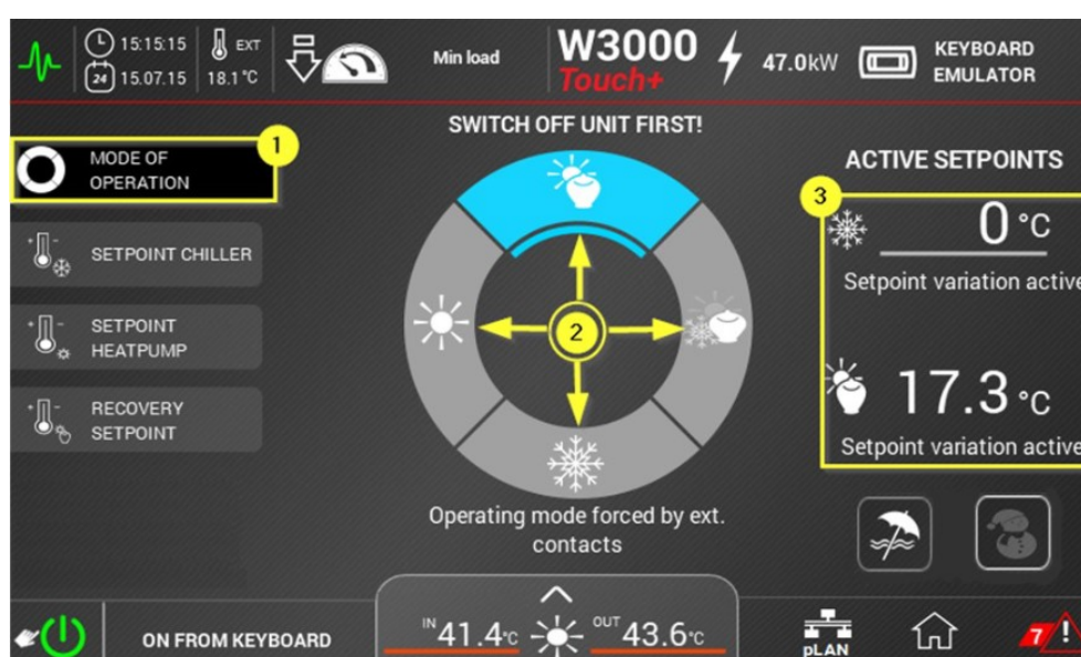
Figura 8.13: impostazione modalità funzionamento
