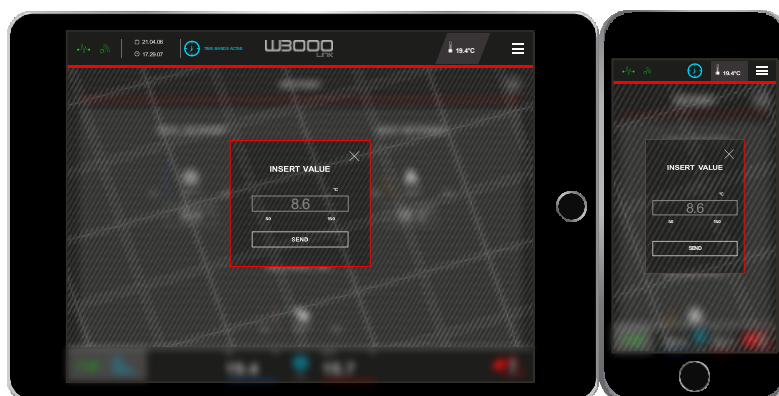
Figura 8.25: modifica valore di Setpoint.
