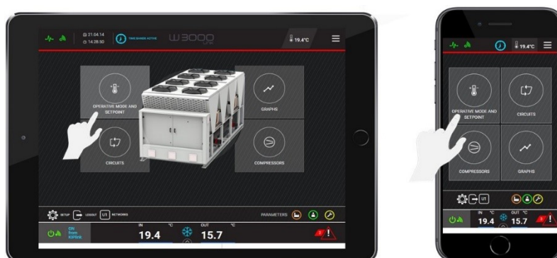
Figura 8.20: accesso modo operativo e Setpoint.
