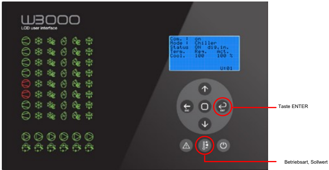
Abbildungen 8.7: Tasten zur Änderung der Betriebsart und zur Bestätigung (ENTER).
