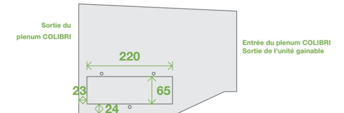
Dans le cas où le plenum serait équipé de l'option isolation 19mm, suivre les côtes suivantes :
