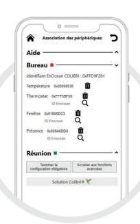
sélectionner le bouton & (accepter) sur le MELZ-B-TH-E-A pour valider. Sinon, sélectionner le bouton 🖰 (Quitter) sur le MELZ-B-TH-E-A pour annuler l'appairage, et sélectionner l'icône **u** à droite de l'identifiant du périphérique qui a été appairé sur l'application web.
