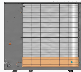
PARTIE CHAUDE DE L'ÉCHANGEUR, GRÂCE À L'INJECTION DE FLUIDE BI-PHASIQUE CHAUD
