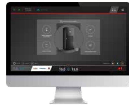
Avec une simple connexion Ethernet, il est possible de connecter KIPlink au réseau local de l'installation et d'obtenir un accès complet au contrôle de l'unité avec un navigateur.
